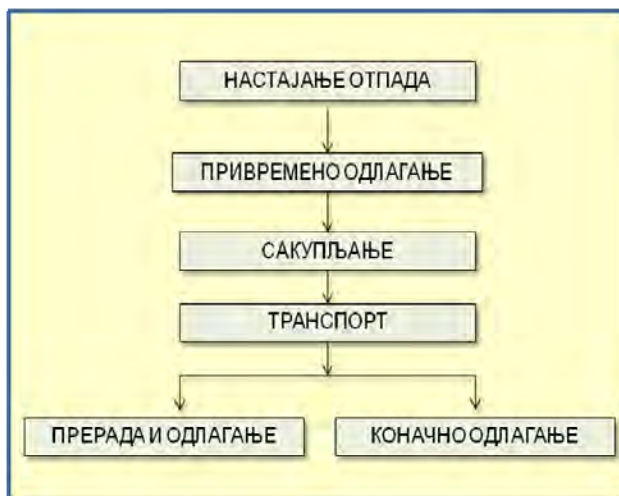
Слика 9. Слика 8. Елементи интегралног система збрињавања отпада
